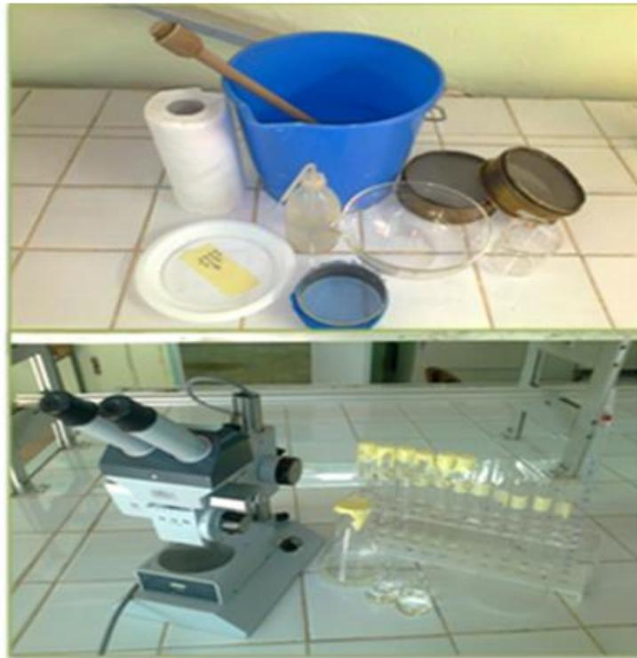
Fig.8. Matériel nécessaire d'extraction des nématodes et l'identification(original 2015)
