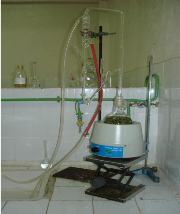
Fig14 : Montage de l'hydrodistillation (Seladji, 2014 ).
