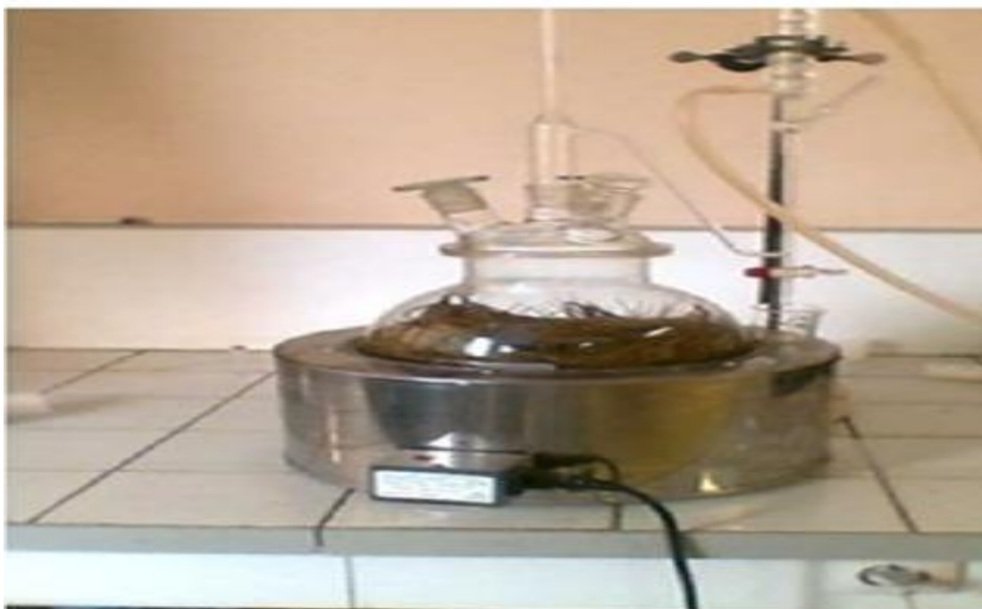
Fig. 17 : Montage d'hydrodistillation (Appareil de type Clevenger selon la méthode préconisée dans la Pharmacopée européenne (Council of Europe,1996 )
