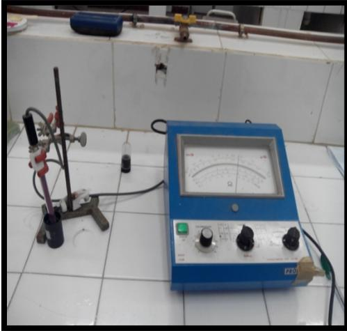
**Photo n°06 : mesure le pH avec le pH- mètre.**
