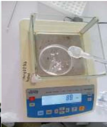
Figure 25 : Balance électronique
