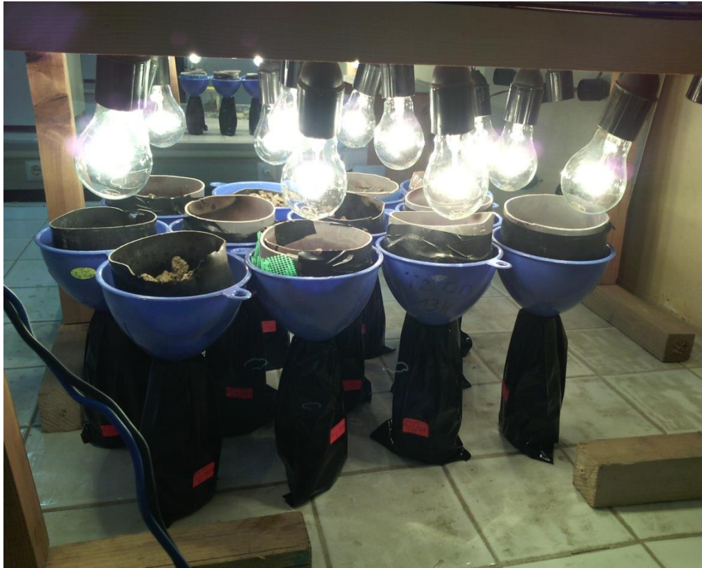
Figure 13 : L'appareil de Berlèse pour l'extraction de la mesofaune du sol au niveau de laboratoire de zoologie (Blida).
