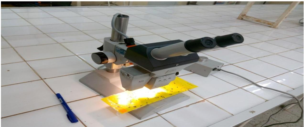
Figure 17 : Matériel utilisé au laboratoire ( loupe binoculaire grossissement 20x ,40x,80x) (original,2017)
