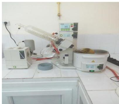
**Figure 9** : Evaporation sous vide par rotavapor des extraits (**Photo originale 2019**).
