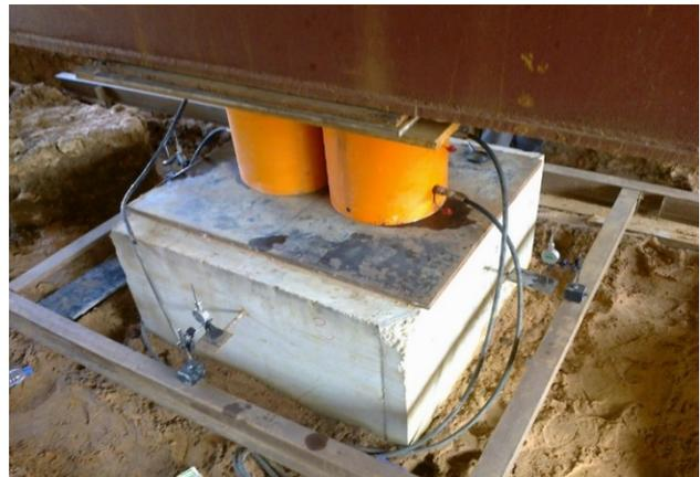
Figure 2.3 : Vérin hydraulique [9].
