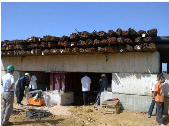
Figure 2.2 : Massif de réaction [9].
