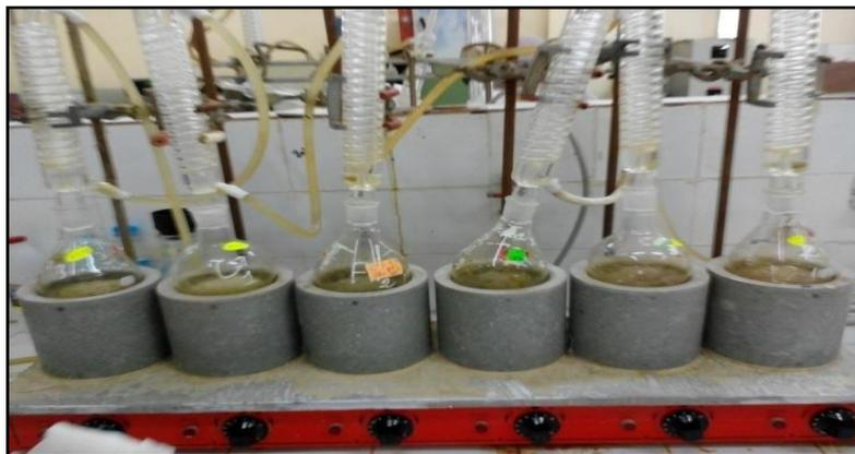
**Photo 08** : Dispositif pour la détermination de la CB.
