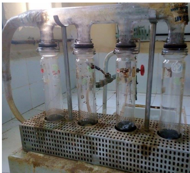
Photo 4 : le minéralisateur utilisé dans la minéralisation.
