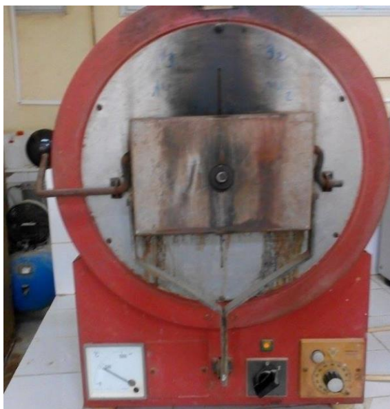
Photo 2 : Le four utilisé pour incinérer l'échantillon
