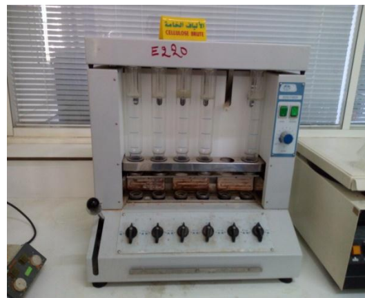
Figure 4 : Extracteur pour cellulose brute
