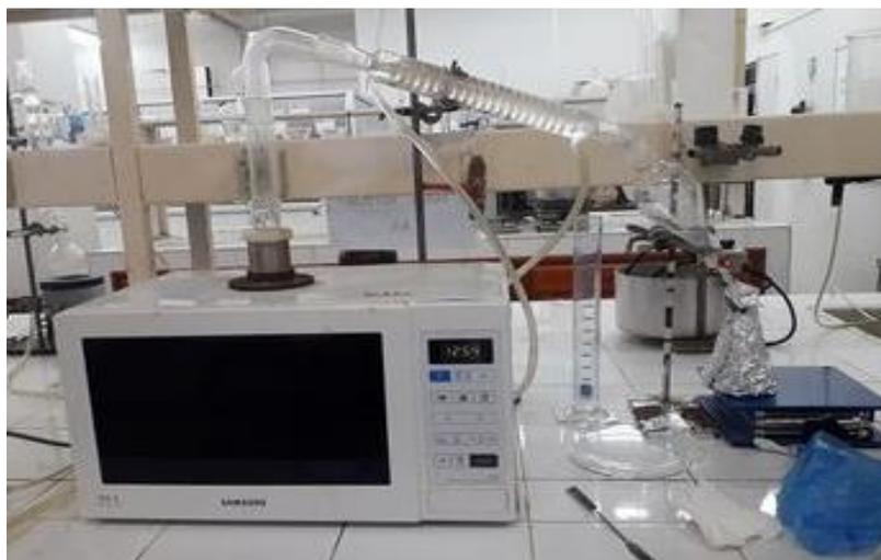
**Figure III.4 :** Montage d'hydrodistillation assisté par micro-onde.
