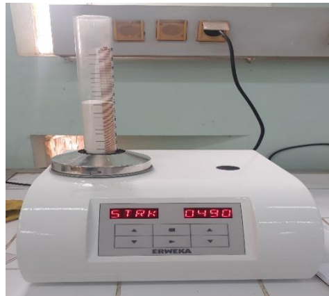
Figure 3.10 : Test de tassement.
