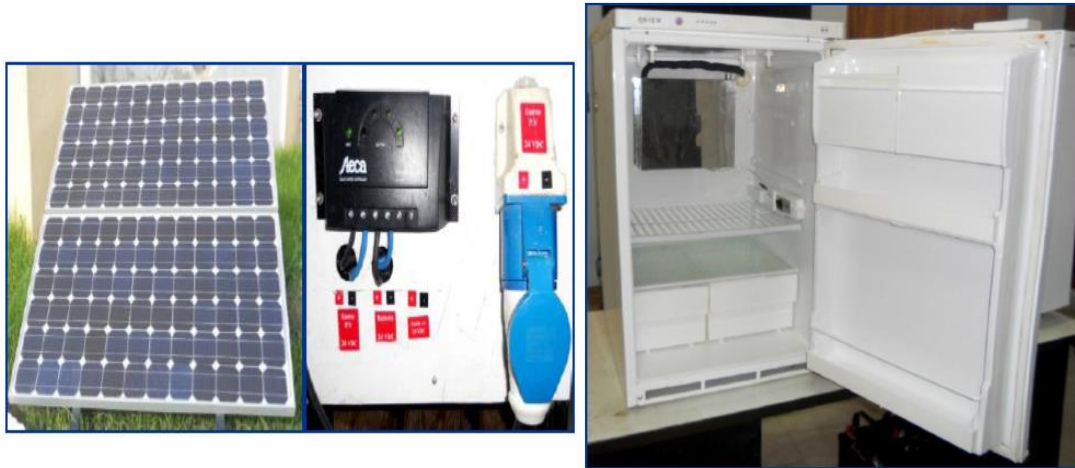
Figure 1.4 : Système de Réfrigération Solaire Photovoltaïque DC/AC de l'équipe Froid photovoltaïque - UDES
