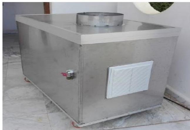
Figure 1.3 : Système de rafraîchissement par évaporation de l'équipe froid thermique - UEDES
