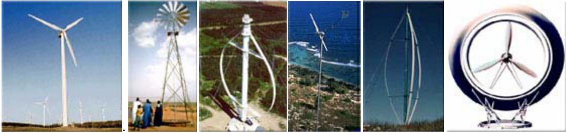
Les 2 types d'éoliennes (Axe Vertical, Axe Horizontal)
