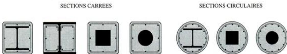
**Figure VIII-9** Exemples de profils enrobés de béton.
