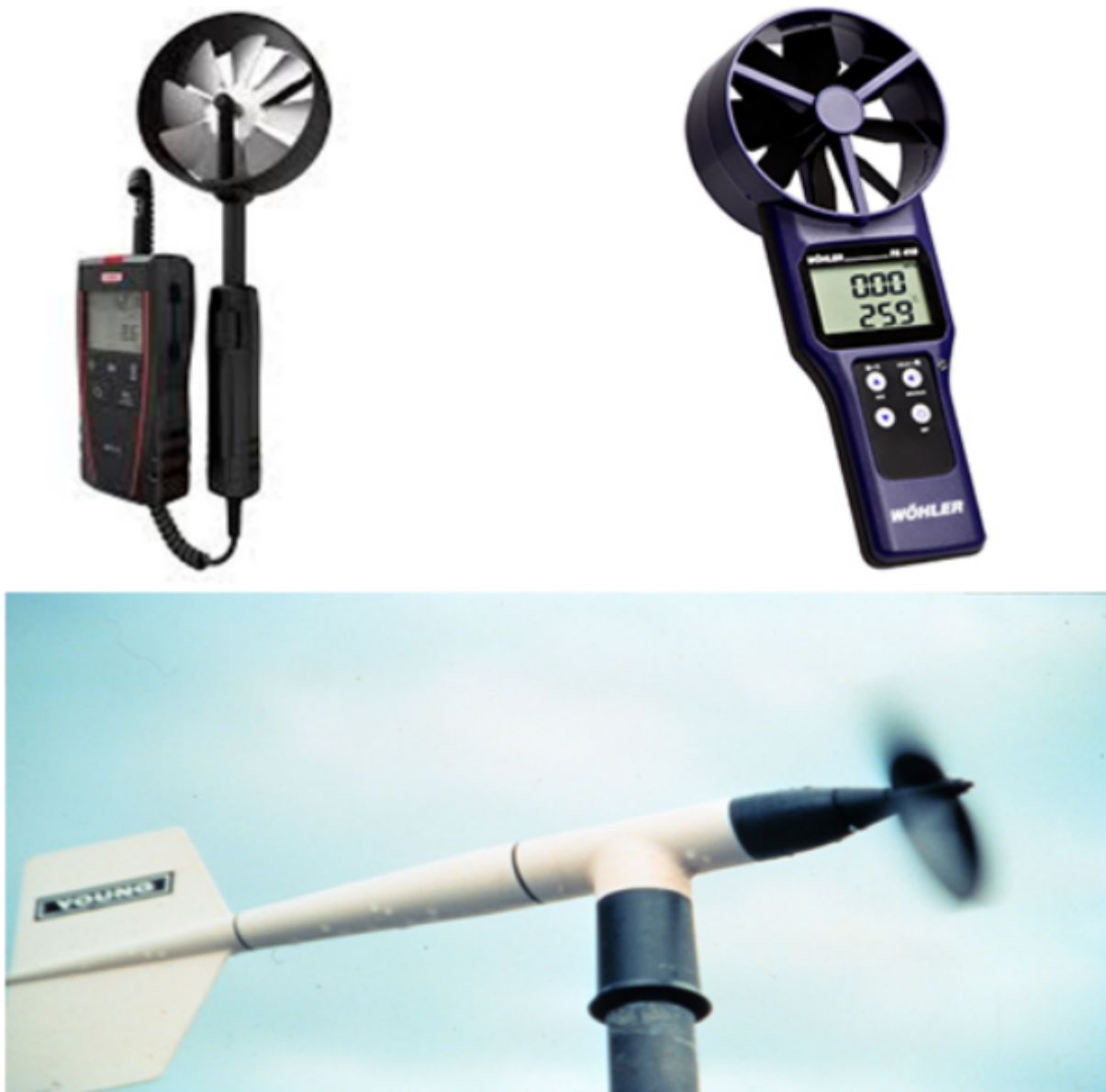
FIGURE 2.7 – des exemples sur un anémomètre à hélice[9].
