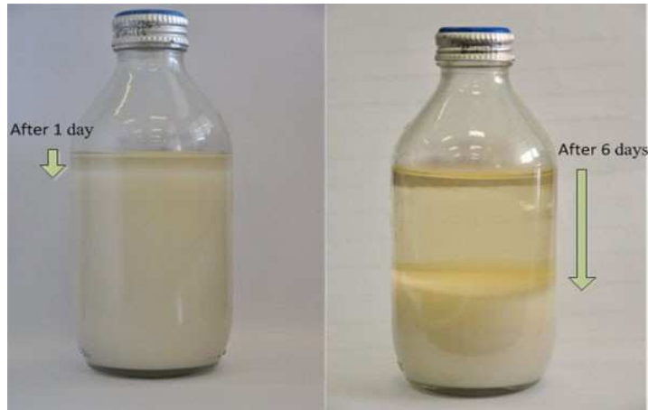
Figure1-2 :Sédimentation de nanofluide due à l'ajout de citrate d'hydrogène ammoniacal DL au fluide de base avant les nanoparticules.
