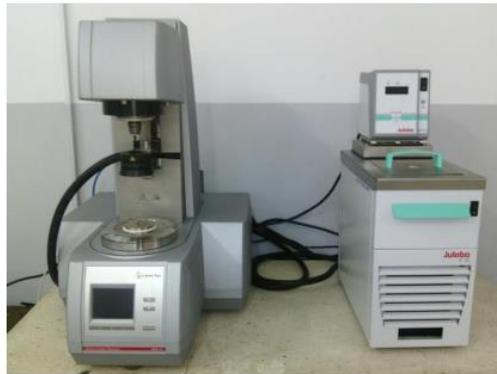
**Figure II.3:** Rhéomètre ANTON PAAR PHYSICA RHEOLAB MCR 302
