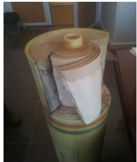
Figure 3.10: Membrane (vue de l'intérieur).
