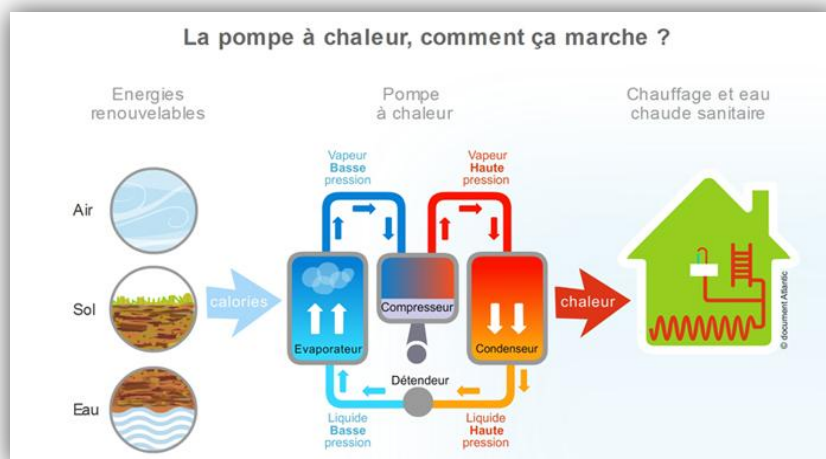
Figure 1-1 : fonctionnement d'une pompe à chaleur [5]
