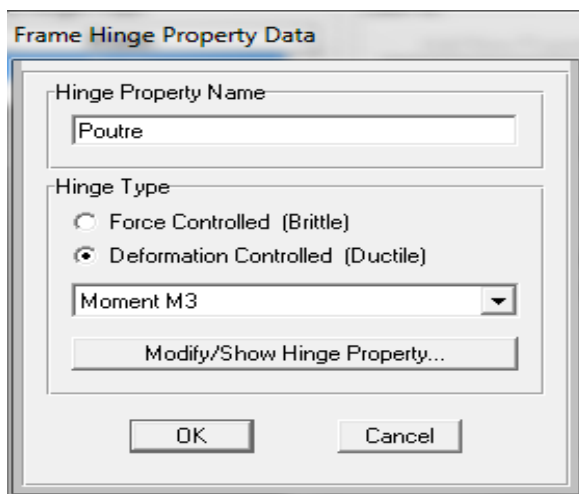
Figure IV.12 : Propriétés des rotules poutres.
