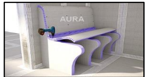
Figure 224 : Banquette hammam (Source : http://detailsconstructifs.cype.fr/ )
