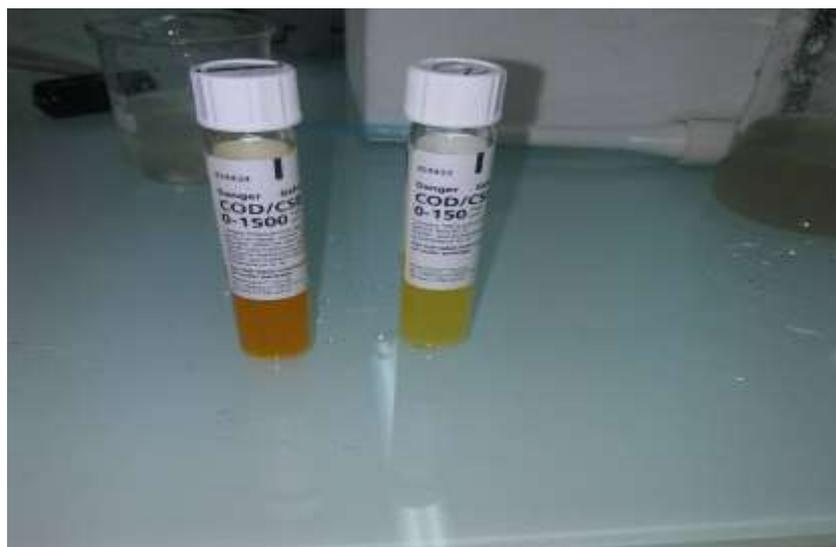
**Figure 13 :** réactif à DCO
