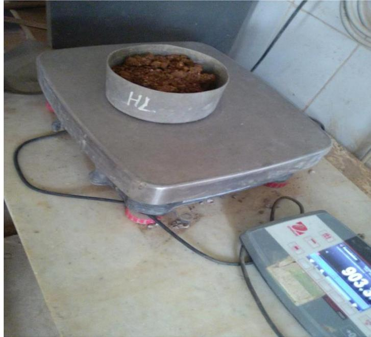
**Figure IV.13 : Détermination de la teneur en eau, (LCTP, Alger).**
