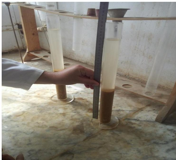
**Figure IV.8 : Equivalent de sable (LCTP, Alger).**
