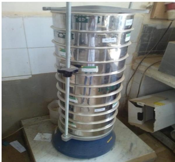
**Figure IV.5 :** Séries de tamis de l'analyse granulométrique (LCTP, Alger).
