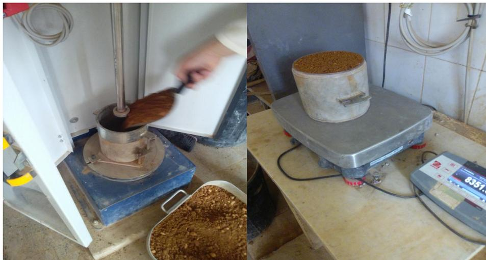
**Figure I.5 : Essai Proctor (LCTP, Alger).**
