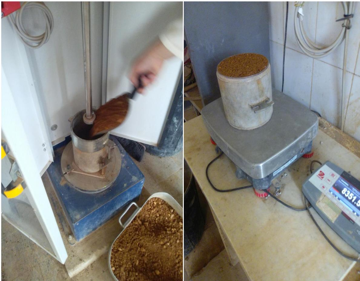
**Figure IV.11 : Essai Proctor (LCTP, Alger).**
