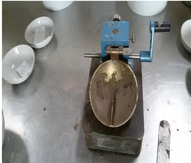
**Figure IV.2** : Réalisation de la rainure dans la pâte de sol au moyen d'un outil spécial.
