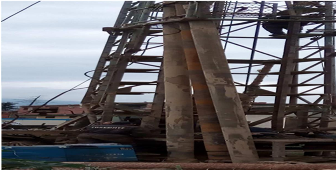
Figure. II-12 : Photo de masses tige [source ; khoumeri. M.L & Sahi. A, chiffa le 15 juin 2020].
