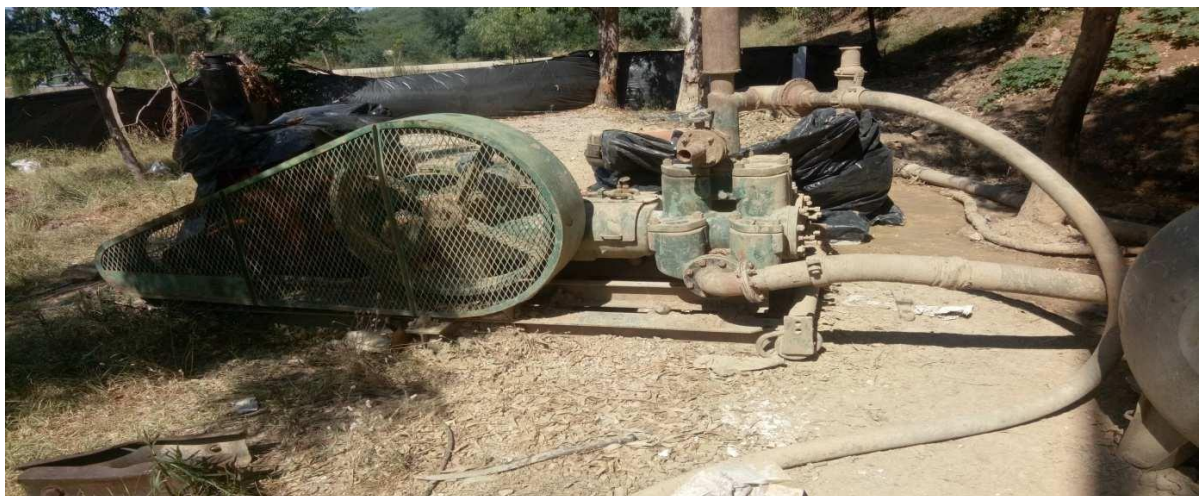
Figure. II-8 : Photo de Pompe a boue [source ; khoumeri. M.L & Sahi.A, chiffa le 15 juin 2020].
