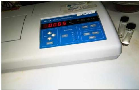
**Figure V.09 : Le turbidimètre**
