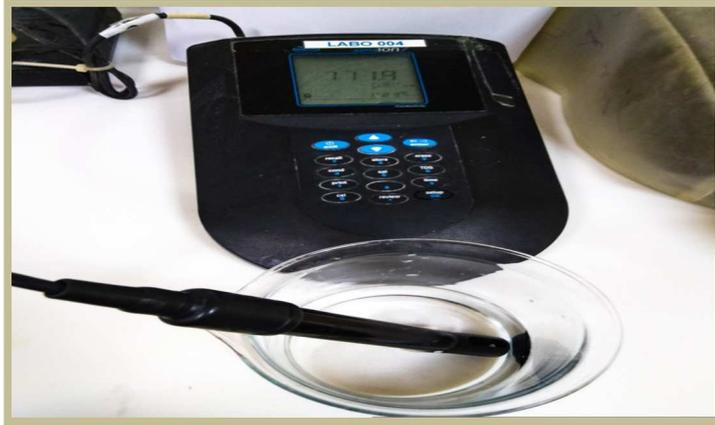
**Figure V.08 : Le conductimètre**
