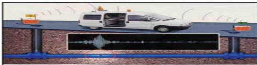
Figure III.6 : schéma décrivant l'ancienne méthode de corrélation.
