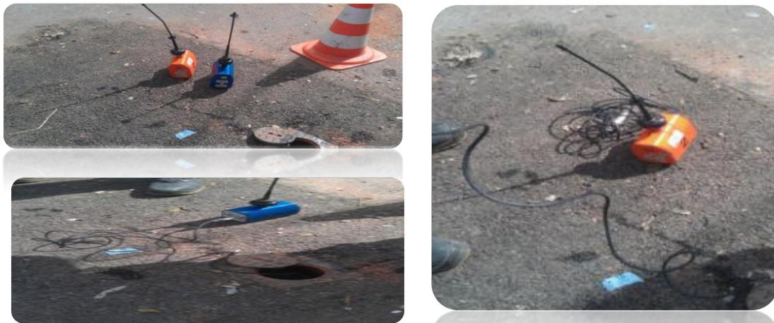
Figure III. 5 : Des corrélateurs (transmetteur et l'émetteur). [ BENARINA,OU.2013]
