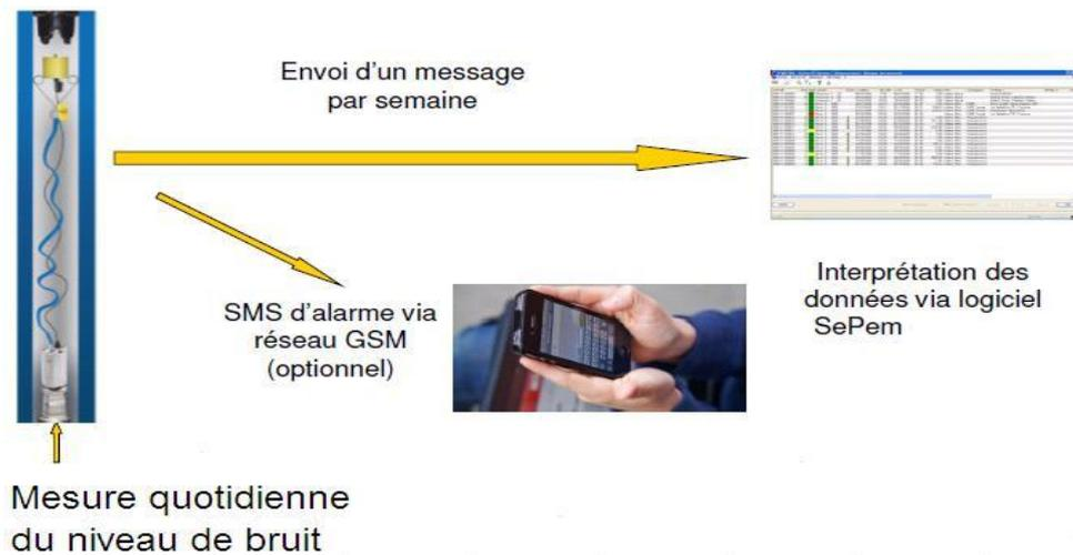
**Figure III.2 :** Principe de la pré-localisation
