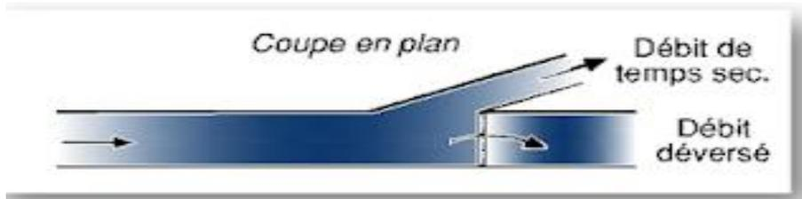
Figure VI.1 Déversoir d'orage à seuil frontal (coupe en plan).
