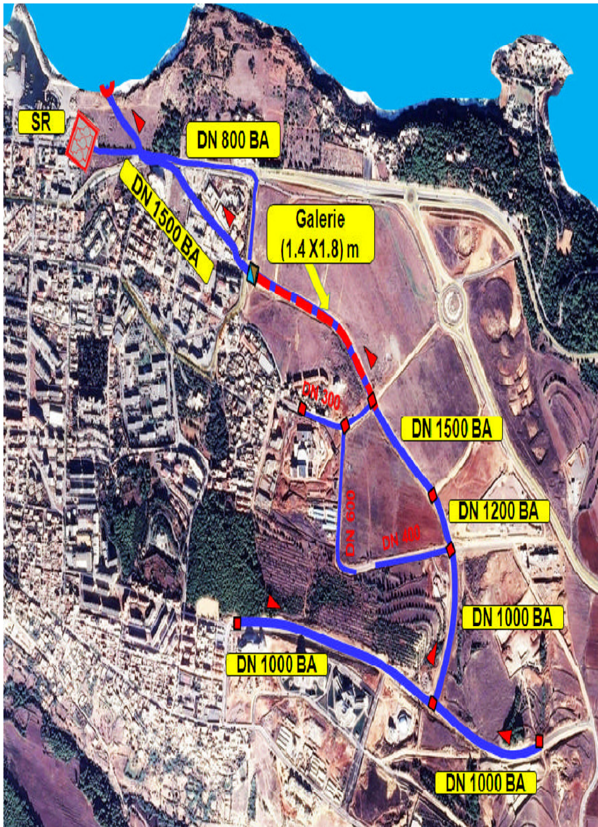
Figure III.2 : Réseau d'assainissement existant
