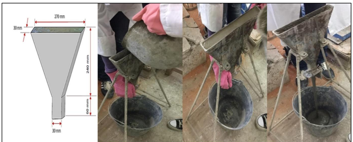
Figure 2.12 : Essai à l'Entonnoir en V pour mortier [21]
