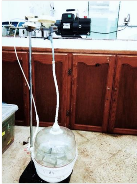
Figure 2.21 : Dispositif de saturation sous vide des éprouvettes
