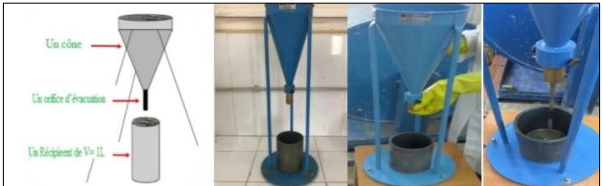
Figure 2. 13 : Essai au cône de Marsh pour mortier
