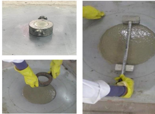
Figure 2.11 : Essai d'étalement pour mortier [21]
