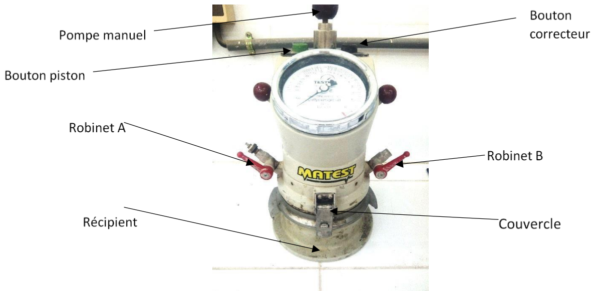
Figure 2.14 : Essai de l'air occlus [32]
