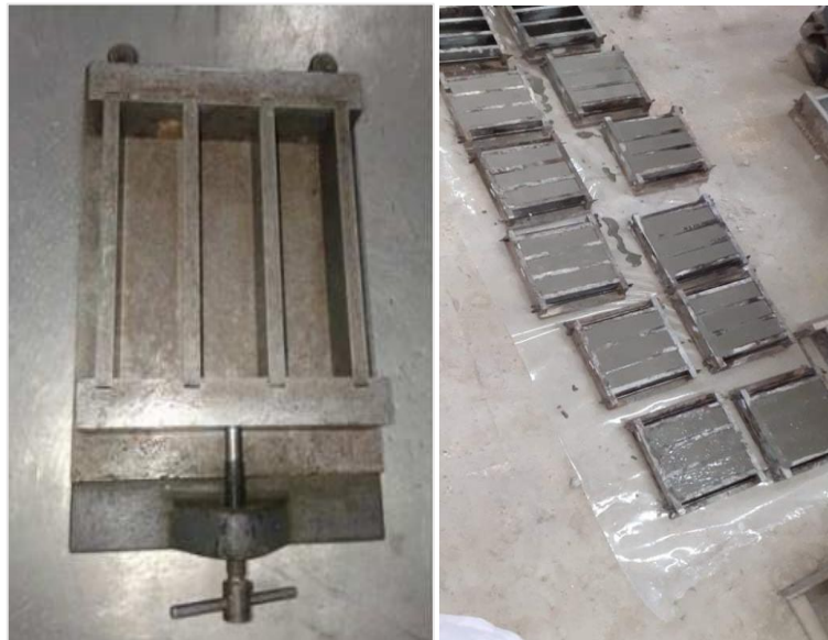
Figure 2.15 : Moule prismatique 4*4*16\text{ cm} vide et rempli de MAP
