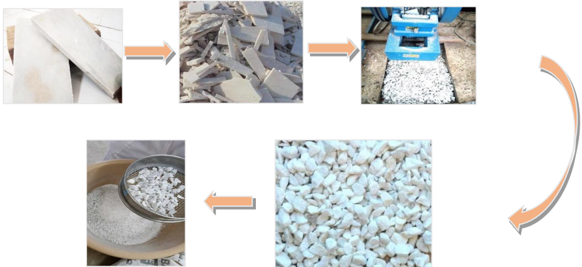
Figure 2.6 : Processus de concassage
