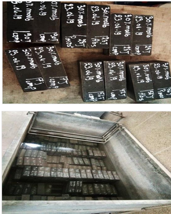
Figure 2.16 : Confection et Conservation des éprouvettes [32]
