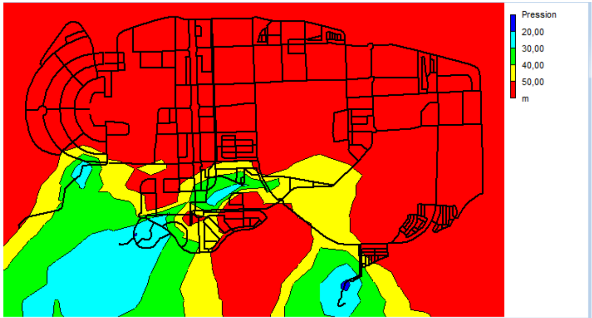
Figure IV-4: Etat des pression dans le réseau permanent
