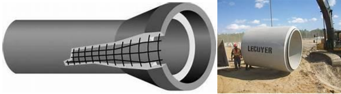
FigureV .3. Conduite en béton armé
