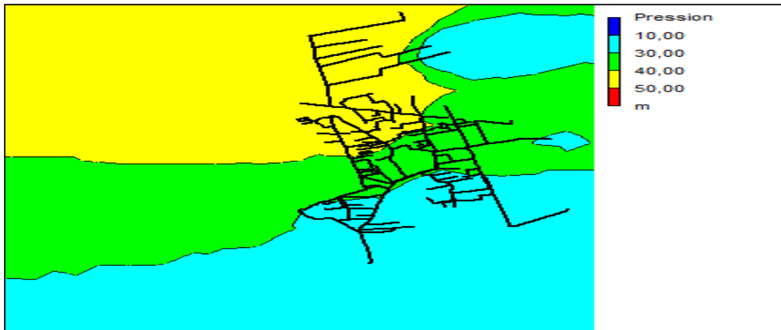
Figure IV.5 : Etat de pressions du secteur 02 cas heure de pointe, Horizon2050.
