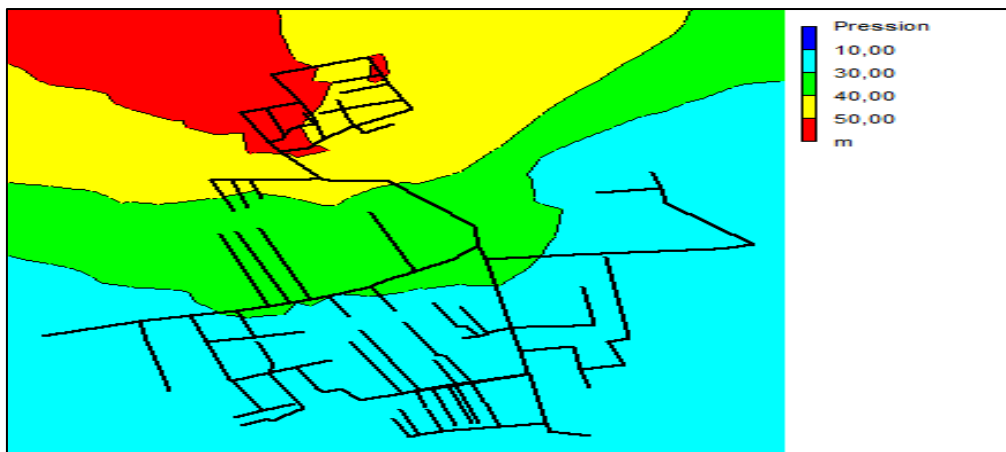
Figure IV.2 : Etat de pressions du secteur01 cas de pointe, Horizon2050.
