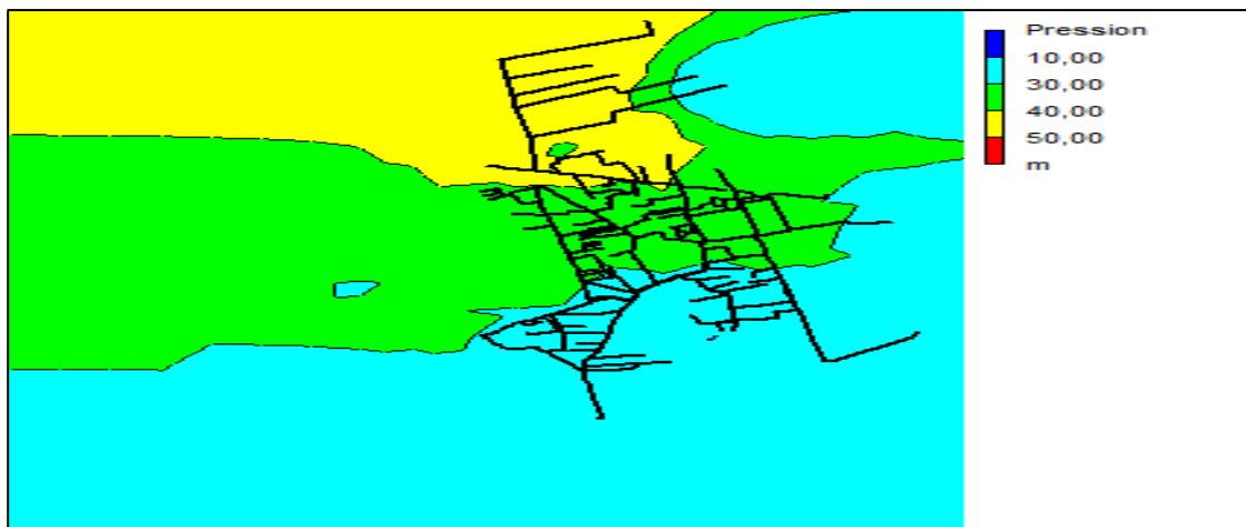
Figure IV.7 : Etat de pressions du secteur 02 cas heure de pointe plus incendie, Horizon2050.
