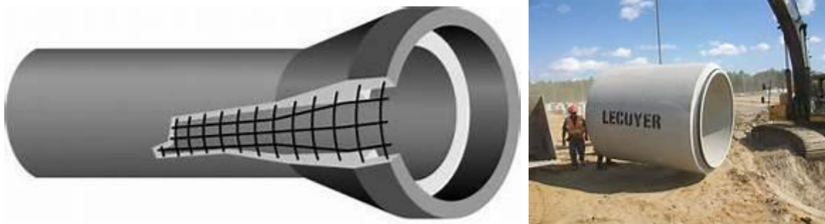
Figure VI.3. Conduite en béton armé(source: Google image)
