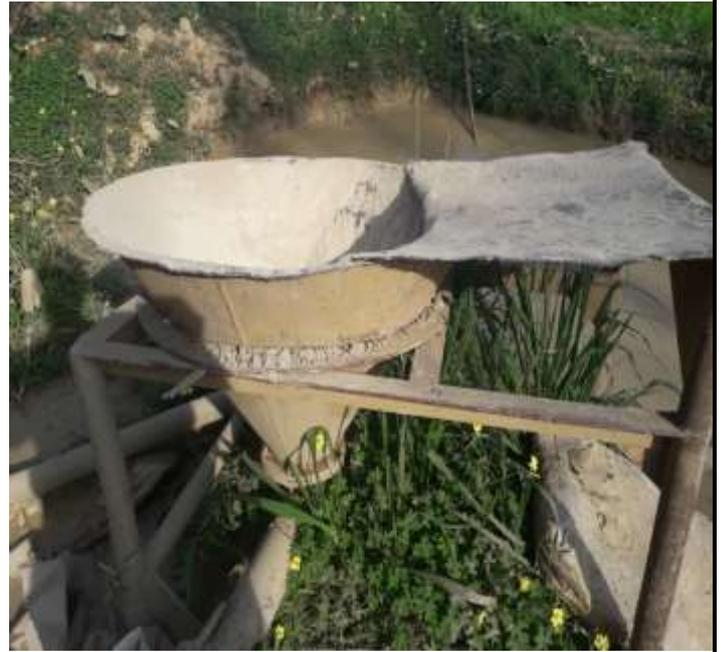
**Photo 12:** Le mixeur et pompe à boue (forage de l'arbaa)
