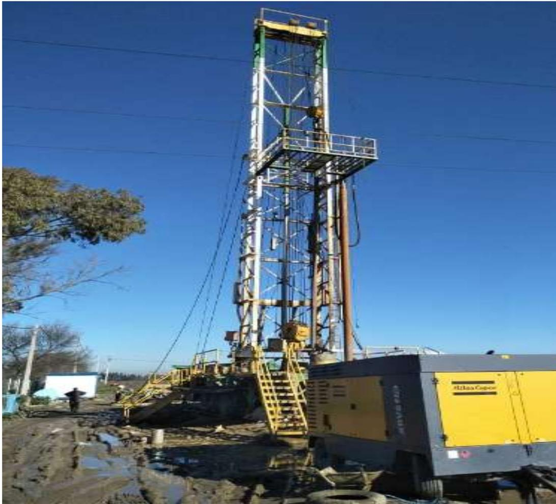
**Photo 1** : Le mat de l'appareil forage (forage de larbàa)
