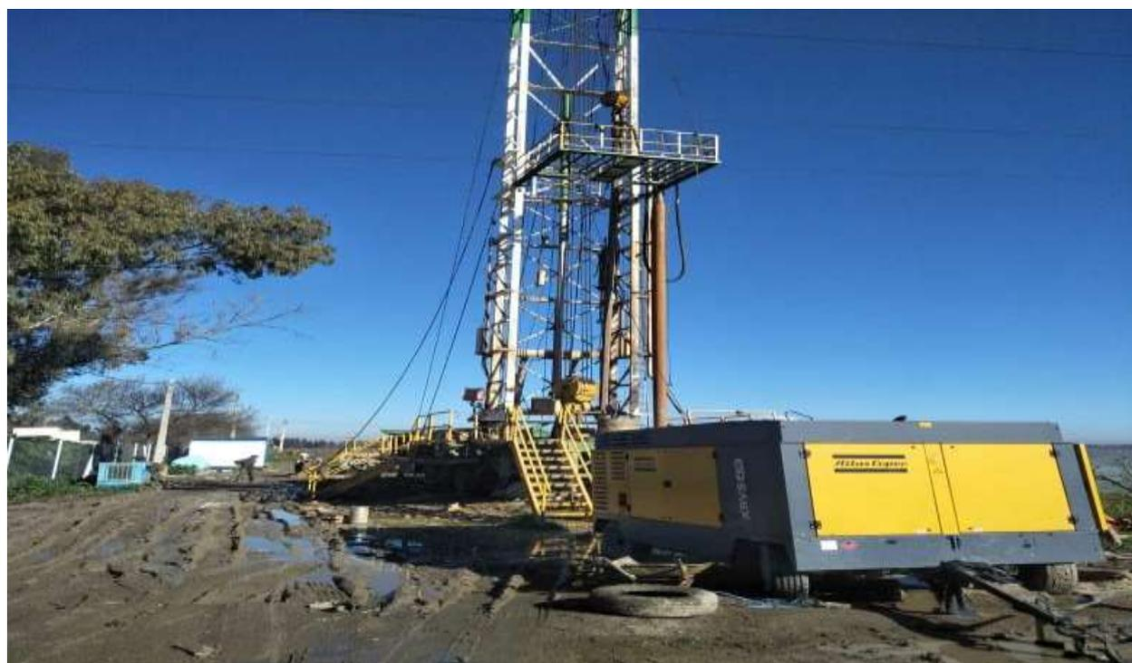
**Photo 25 :** Compresseur d'air (forage de l'arbaa)
