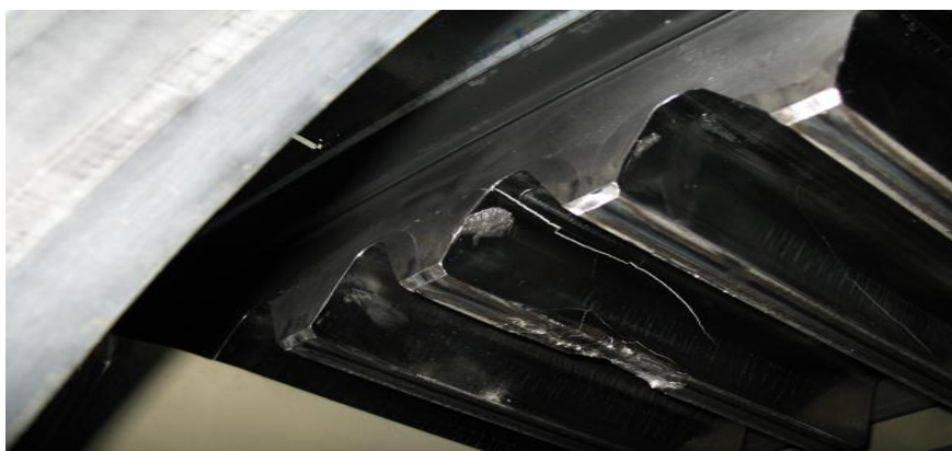
Figure N° 30 : défaut fissure d'une dent d'engrenage
