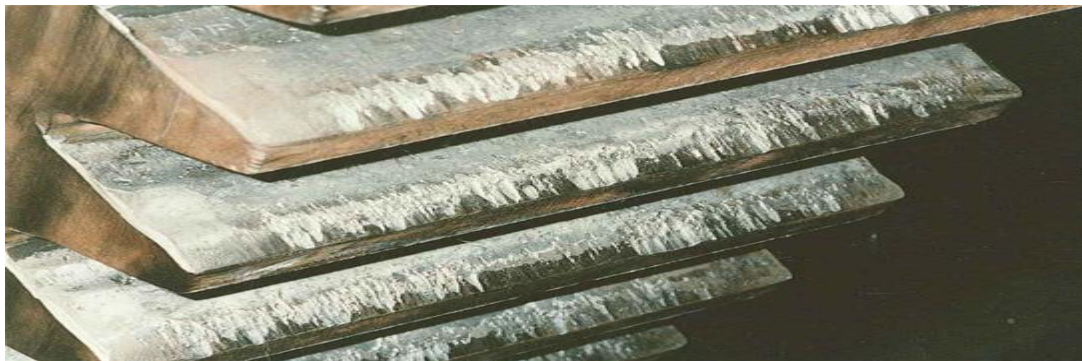
Figure N° 32 : défaut grippage localisé sur les têtes de dent
