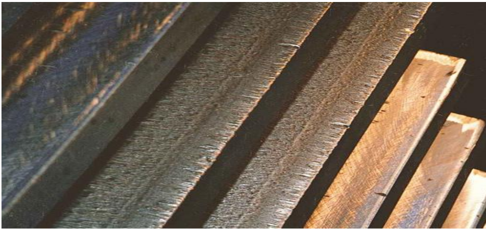
Figure N° 28 : défaut Grippage couvrant l'ensemble des dentures
