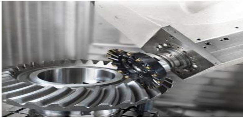
Figure N° 39 : Exemple d'opération de fraisage à la fraise module d'un pignon à denturesspiro-conique (source Gearsolutions ).
