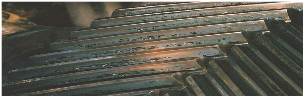
Figure N° 27 : défaut pittings évolutifs sur une roue chevron
