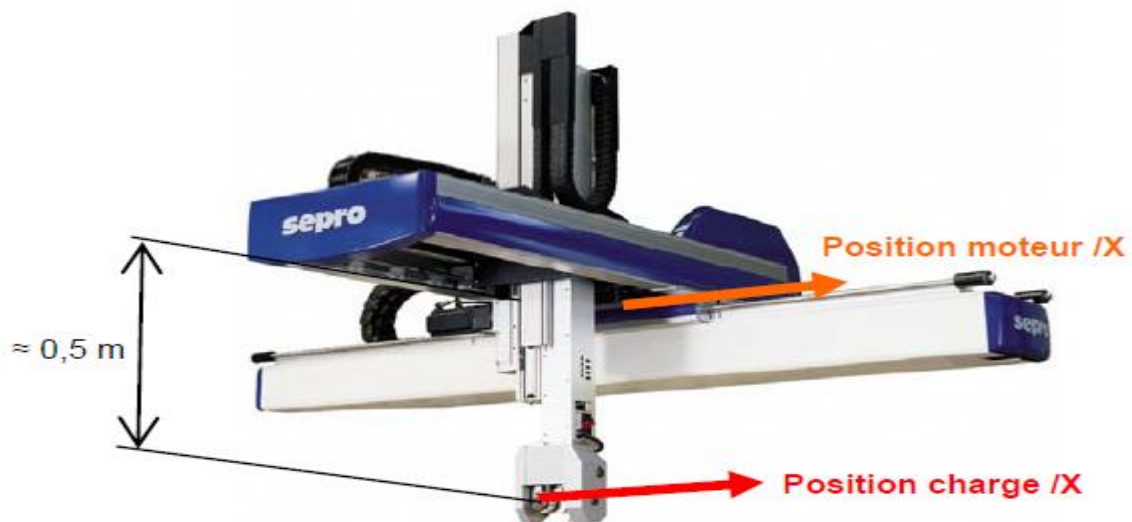
Figure 1.7 : Exemple de structure agile : Robot cartésien [21]
