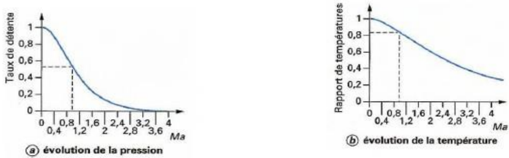
Figure II.4 – Evolution de la pression et de la température dans un écoulement isentropique d’air en fonction du nombre de mach.
