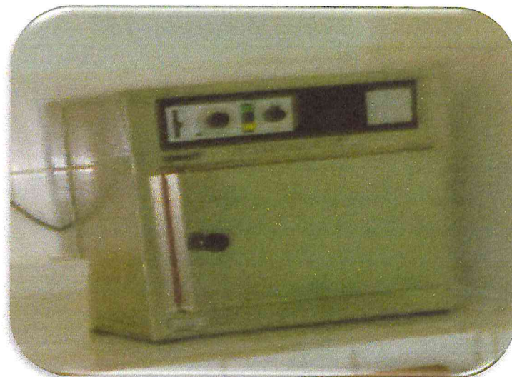
Figure N°18: Stérilisation par le poupinel à une température de 170 °C .
