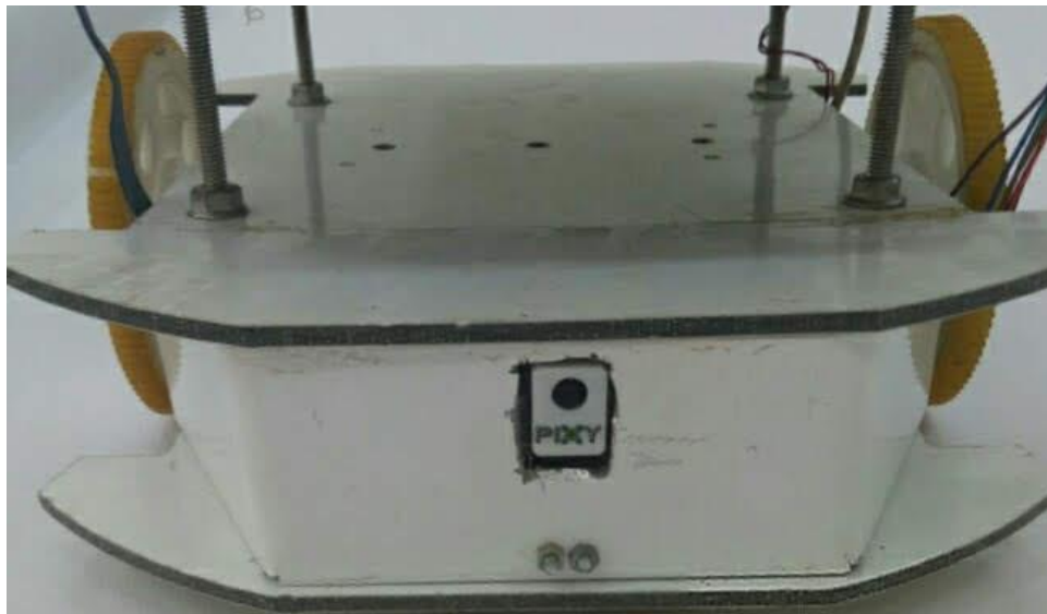
Figure 3.4.3 : L'emplacement de la caméra dans le robot mobile
