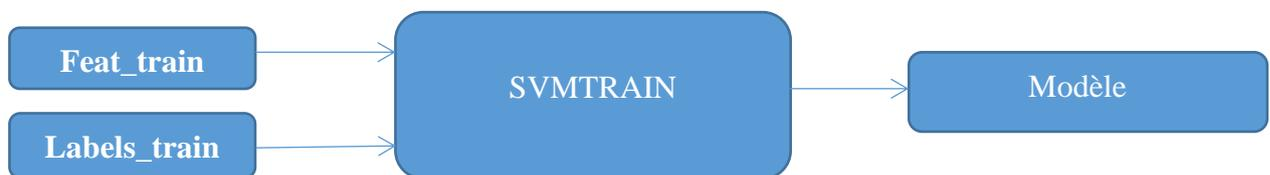
**Figure 3.7:** Déroulement de la phase d'apprentissage du modèle SVM.
