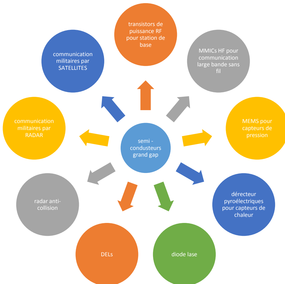
Figure I-2. Exemples d'applications des semi-conducteurs grands gaps. [02]
