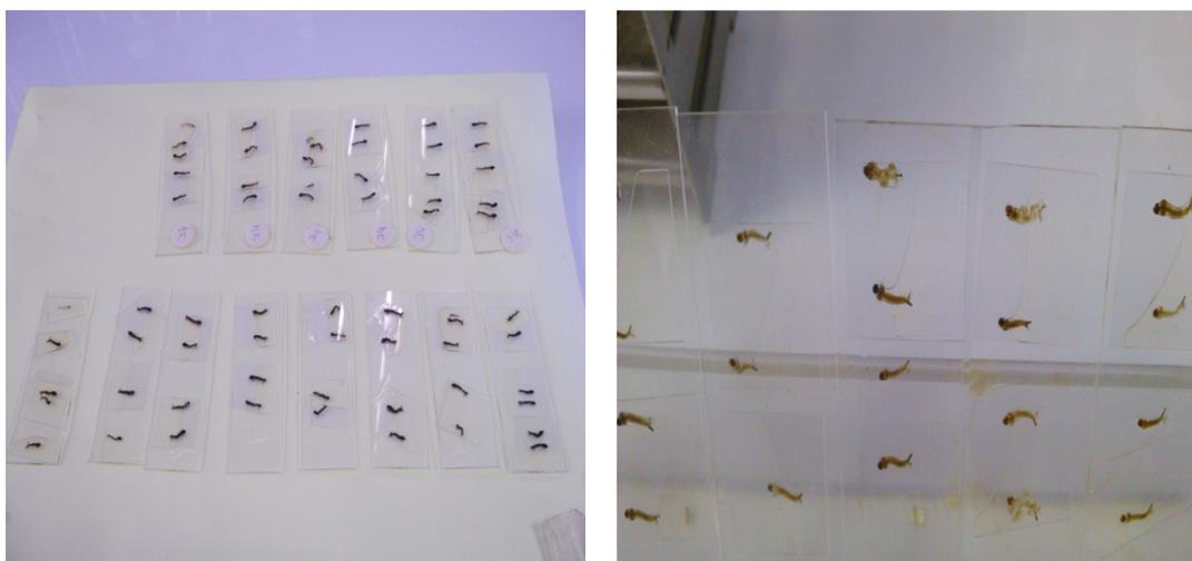
**Figure 19 :** Montage des spécimens sur lame lamelle
