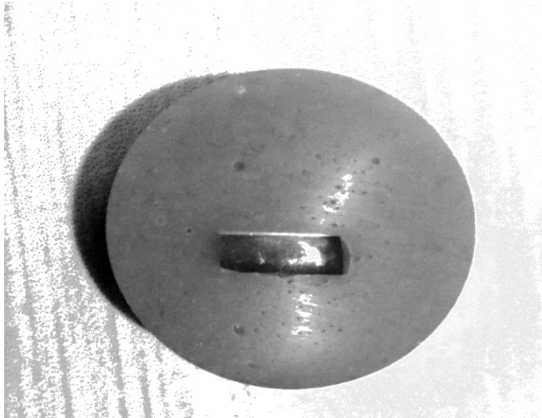
**Figure III.2:** Notre échantillon enrobé à froid.
