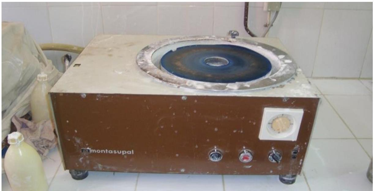
**Figure III.4:** Polisseuse de finition.
