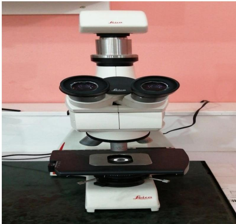
**Figure III.5:** Microscope optique Leica DM750M.
