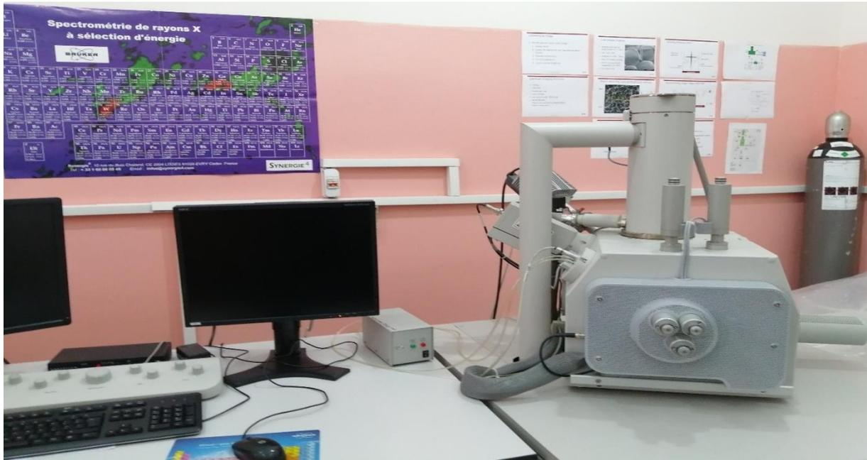
**Figure III.7:** Microscope Electronique à Balayage (FEI QUANTA 650) au niveau de laboratoire FUNDALP.
