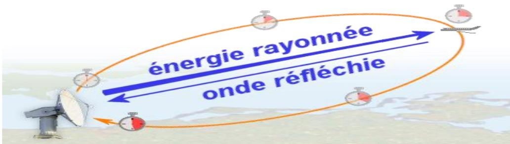
**Figure I. 2 :** Principe de l'émission du radar
