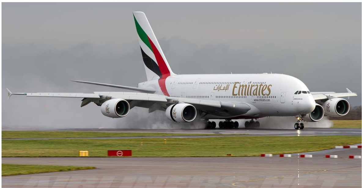
Figure 4.2 : Inversion de poussée avec les réacteurs intérieurs de l'A380
