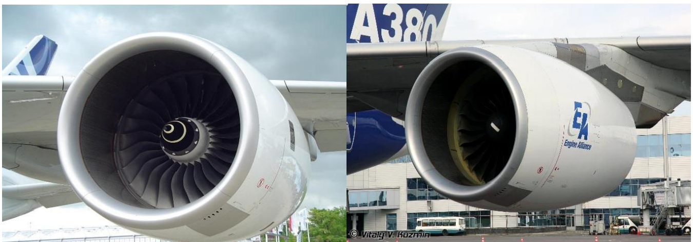
Figure 1.8 : Réacteur RB211 Trent 970B-84 (à gauche) /Réacteur GP7270 (à droite)
