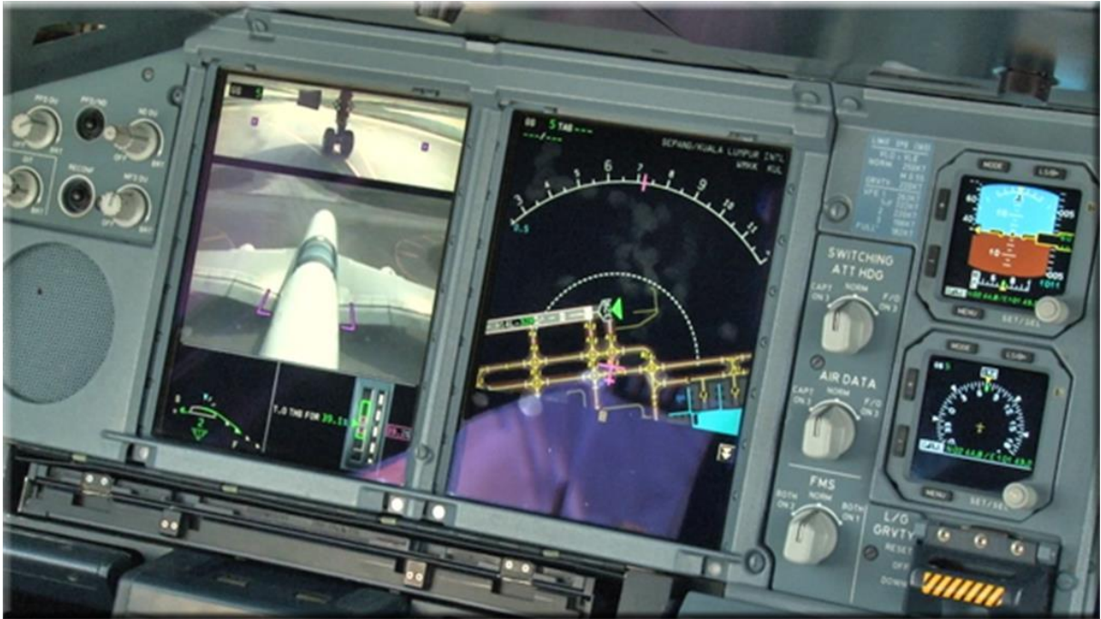
Figure 4.6 : Vues des caméras externes dans le cockpit de l'A380.
