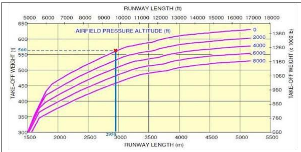
Figure 3.1 : Distance nécessaire au décollage (GP 7200) ISA+15°C.
