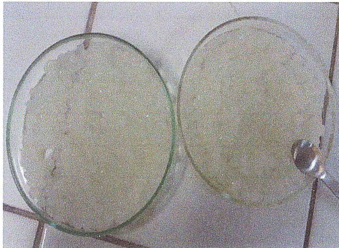
Figure (11) : Billes d'alginate précipitées dans une solution de chlorure de calcium et en cours de maturation
