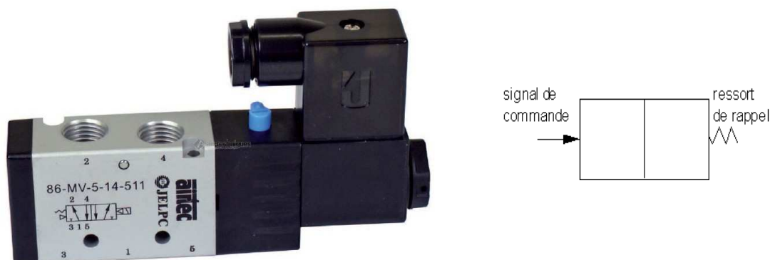
Figure 2.2 : Distributeur 5/2 monostable commande électrique
