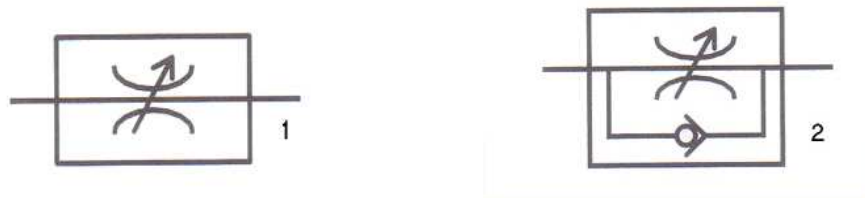
Figure 2.15 : Symbole des limiteurs de débit bidirectionnel et unidirectionnel
