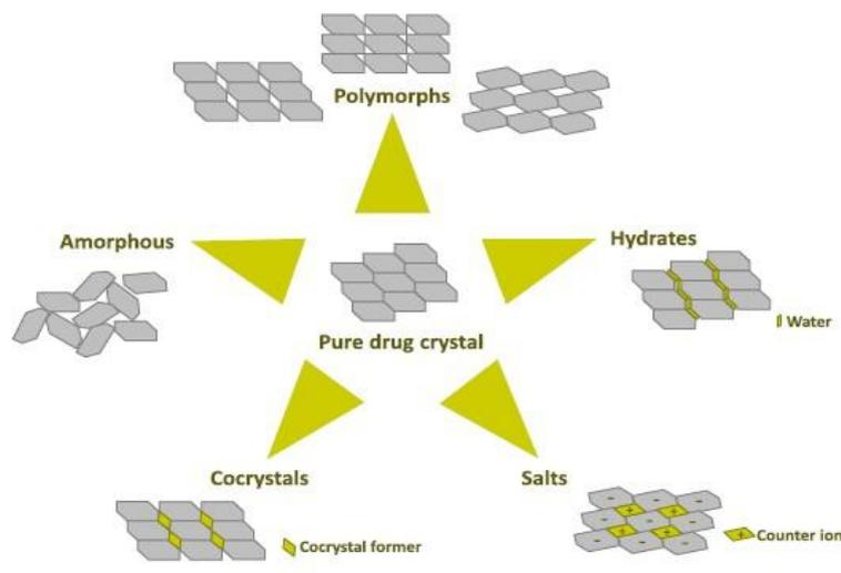
**Figure 2.1 :** Différentes formes solides de médicaments qui peuvent être utilisées dans des formulations, y compris le cristal de médicament pour le plus stable, ainsi que des polymorphes, des hydrates, des sels, des Co-cristaux et des formes amorphes [48].
